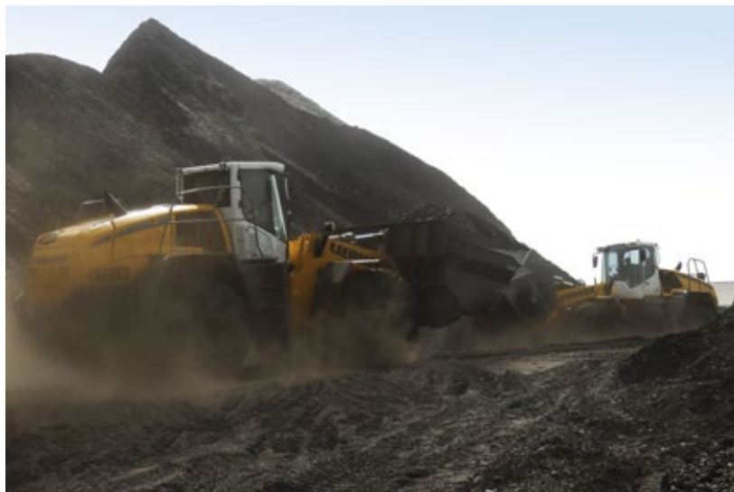
Два L 580 доставляют уголь на основной ленточный конвейер
