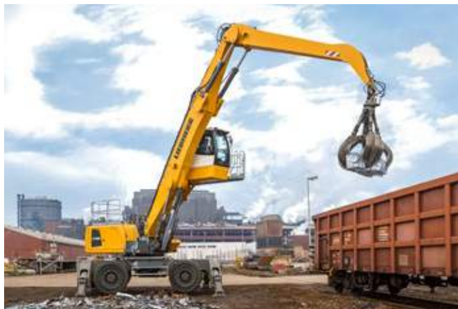
Загрузка прессованных алюминиевых пакетов в вагоны с помощью LH 50 M Industry Litronic
