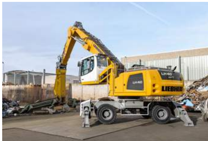
LH 40 M Industry Litronic при резке стальных балок с помощью ножниц
