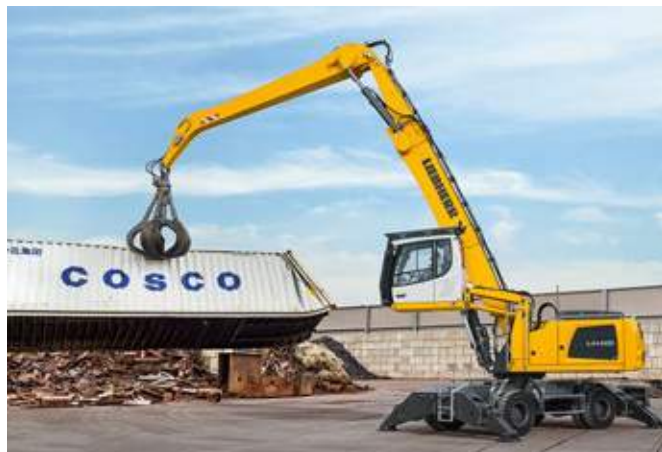
Разборка контейнера с помощью LH 40 M Industry Litronic
