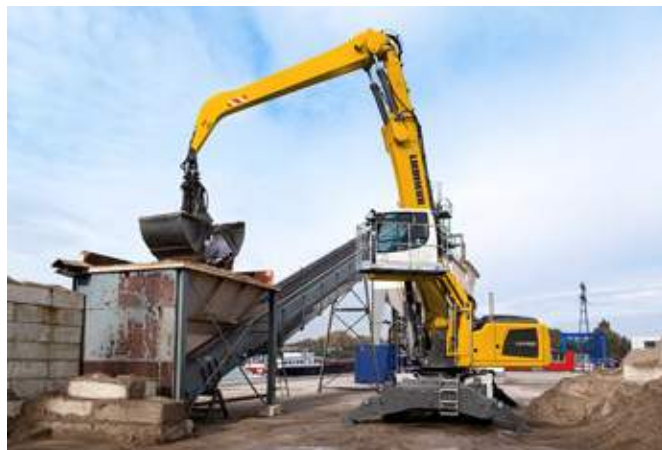
Загрузка бетономесительной установки с помощью LH 40 M Industry Litronic
