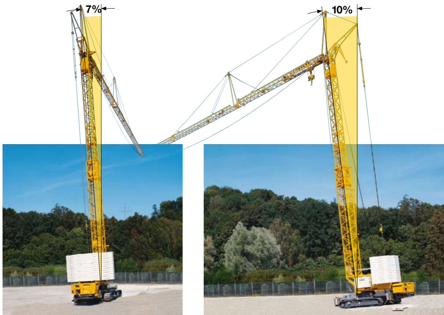
С хорошей проходимостью: поперечное отклонение до 7%...
