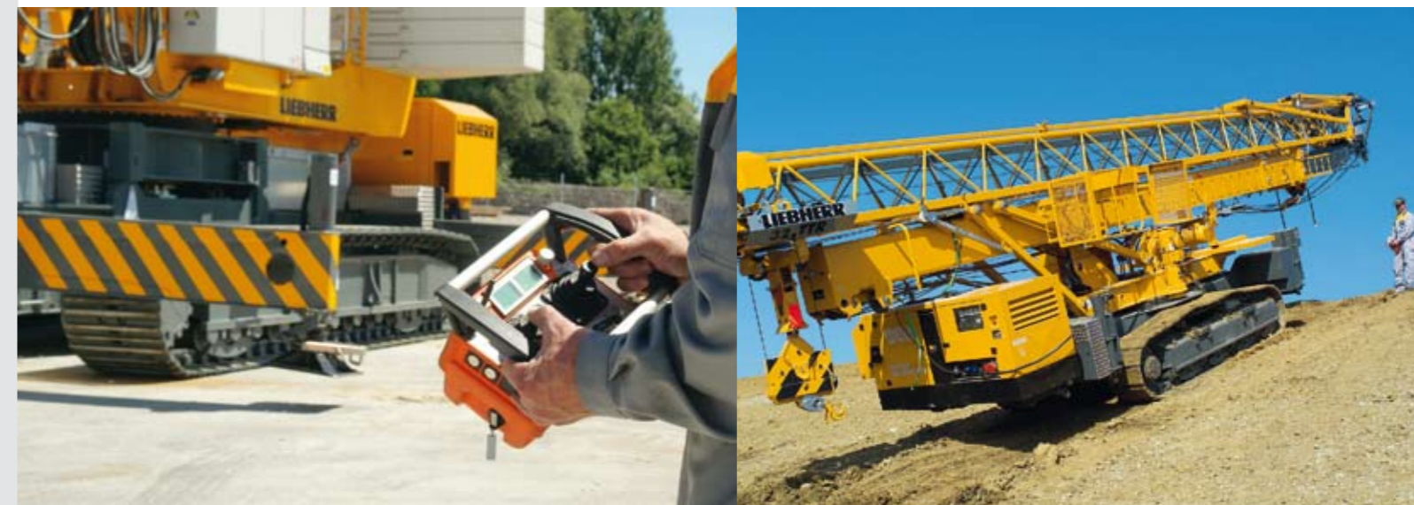
Беспроводное передвижение: простое управление при помощи пульта дистанционного управления
