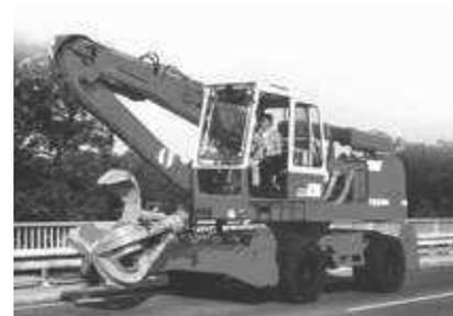
Первый гидроподъемник кабины
