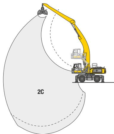
Измененная кривая выемки с увеличенной глубиной, например, для разгрузки грузов из трюмов судов
