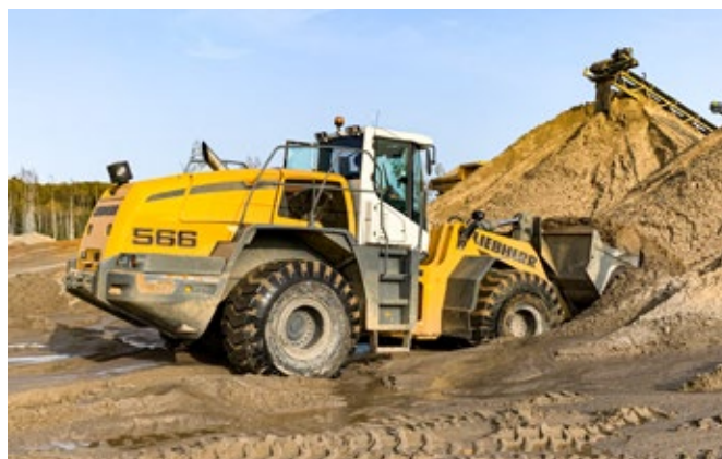
В периоды пиковой загрузки один колесный погрузчик L 566 работая в две смены по 11 часов перегружает свыше 5 500 м 3 материала за сутки.
