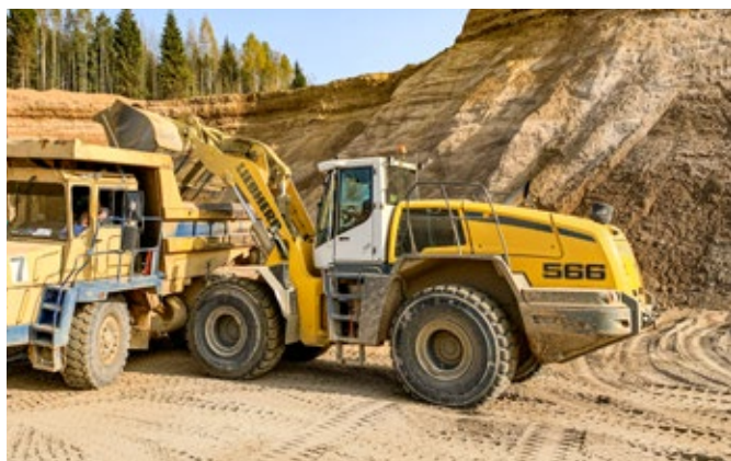
Либхерр L 566 оснащен ковшом для сыпучих материалов объемом 4,0 м 3 .
